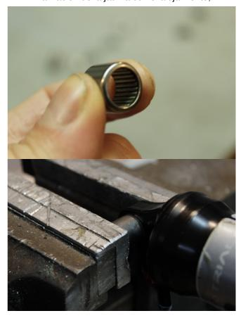
Introducir el eje en el interior de la jaulilla de agujas, antes asegurarse que la agujas estan bien colocadas y que no se hayan movido antes de introducir el eje. El eje debe entrar suavemente con la mano. Un poco de grasa ayuda a una vida mas larga del montaje
